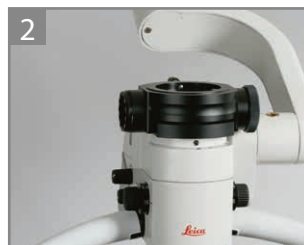
2 Установите светодетель. Для наблюдения 50/50 % или 70/30 %.
