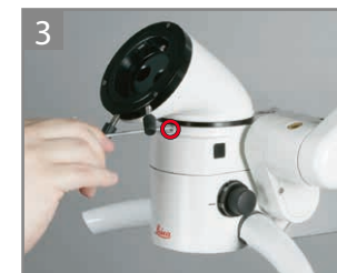
3 Затяните зажимной винт.
