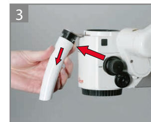
3 Нажмите кнопку и отсоедините втулку рукоятки.
