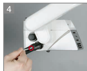
4 Приверните держатель втулки рукоятки.
