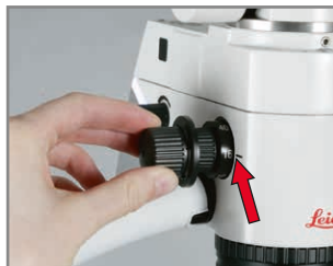
Регулятор увеличения с двух сторон, кратность: 6.4, 10, 16, 25, 40x
