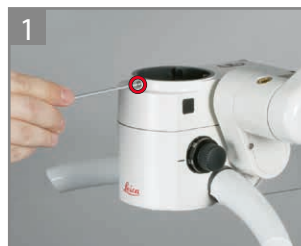
1 Выверните зажимной винт.
