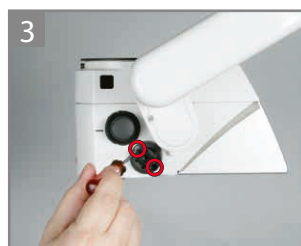
3 Приверните нижний держатель рукоятки. Наклон рукоятки регулируется.
