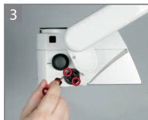
3 Прикрутите нижний держатель рукоятки. Наклон рукоятки регулируется.
