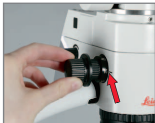
Регулятор увеличения с двух сторон, кратность: 6,4, 10, 16, 25, 40x
