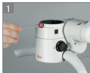
1 Выкрутите зажимной винт.
