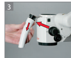
3 Нажмите кнопку и отсоедините втулку рукоятки.
